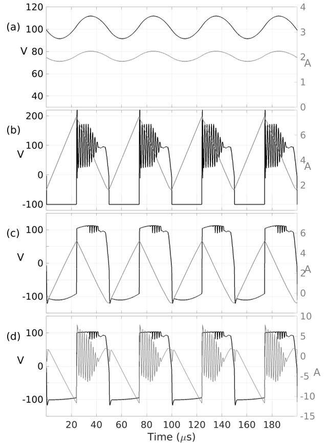
Fig. 4: Simulation, uncoupled MC: (a)  $V_{out}$  and  $i_{out}$ . (b)  $V_{Ls}$  and  $i_1$ . (c)  $V_{Ls}$  and  $i_2$ . (d)  $V_{T1}$  and  $i_{T1}$ .
