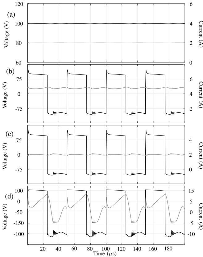
Fig. 5: Simulation results for the proposed IM: (a)  $V_{out}$  and  $i_{out}$ . (b)  $V_{Ls}$  and  $i_1$ . (c)  $V_{Ls}$  and  $i_2$ . (d)  $V_{T1}$  and  $i_{T1}$ .
