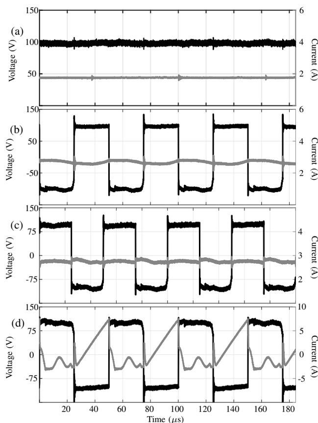
Fig. 8: Experimental results for the proposed IM: (a)  $V_{out}$  and  $i_{out}$ . (b)  $V_{Ls}$  and  $i_1$ . (c)  $V_{Ls}$  and  $i_2$ . (d)  $V_{T1}$  and  $i_{T1}$ .
